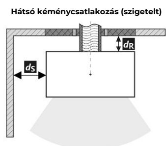
A füstcső áthaladása éghető anyagból készült falon
